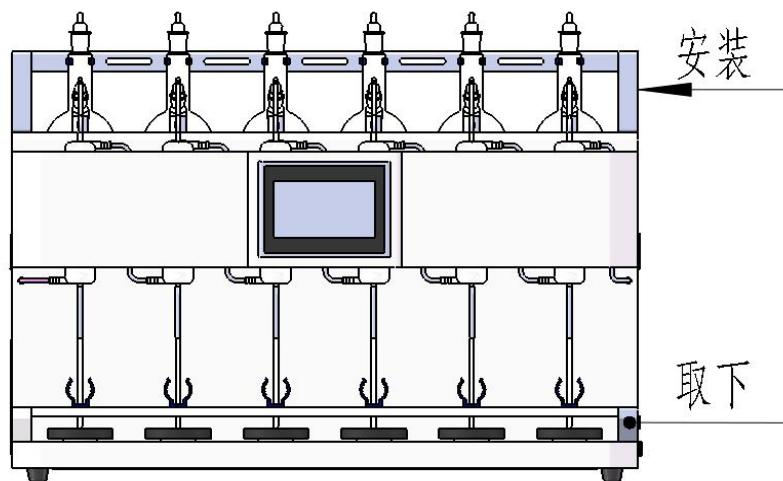
将进出水管连接冷水机，将废液管放入废液桶中（废液桶需用户自备，最好为聚乙烯桶，能耐高温）。
