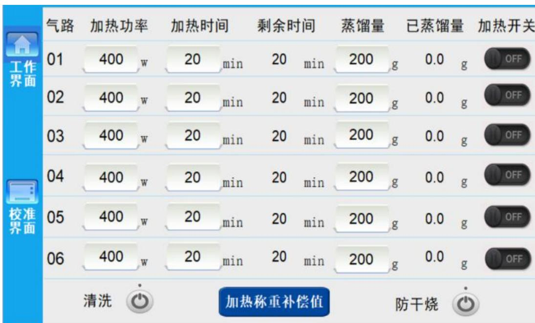
将待清洗通道对应锥形瓶中装入约 200mL 的纯水，然后将专用清洗接头插入对应通道的两口烧瓶 24#磨砂口上；点击“清洗”按钮，则清洗泵立即启动，将锥形瓶中的纯水抽吸到烧瓶中，从而清洗整个馏出液管路；待锥形瓶中的清水抽完后，关闭“清洗”按钮，将专用清洗接头拔出，继续完成其他通道管路的清洗。
