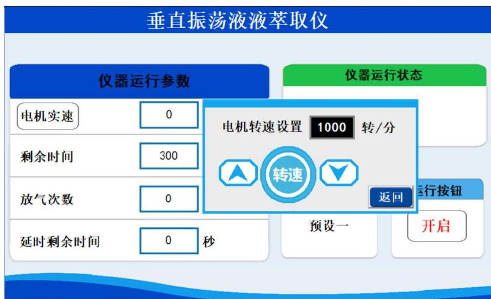
按上下箭头按钮，微调节电机转速快慢，也可直接手动输入快速调节。
