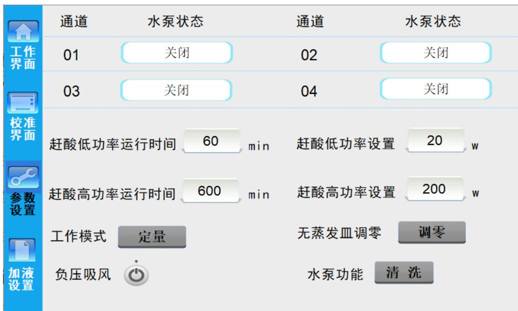
工作模式设置“定量”、“非定量”、“单次蒸干加热”模式的切换。“定量”模式时，水样总量设置有效；“非定量”模式时，水样总量设置无效，直到把水样抽干才停止工作；“单次蒸干加热”模式，适用于做溶解性总固体等不需要自动添加溶液，只需要将固定体积溶液蒸发完全的项目，开启这个模式后，设置水样总量，点击加热开关，仪器不自动添加样品，只将蒸发皿中的溶液蒸干后停止加热，加热前应先将装有溶液的蒸发皿放置在相应加热位。
